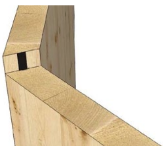
DETAIL ROHOVÉHO SPOJE (cca 135° a více), VS 124, 84 a 62 / Detail von Eckverbindung (ca. 135° und mehr) 124, 84 und 62
