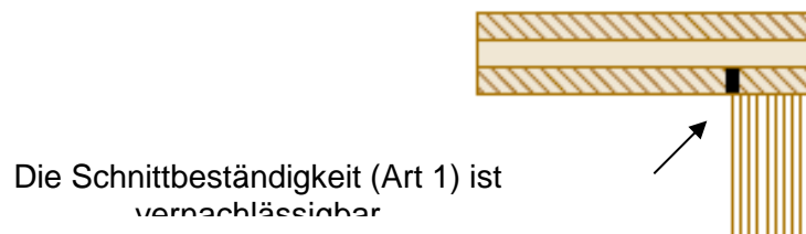
Abbildung 15: Die Schnittbeständigkeit der Außenrippen am Plattenrand ist vernachlässigbar (BSH, LVL)
