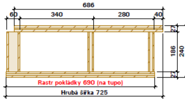
Abbildung 5: NOVATOP element (Standardbreite 0,69 m)
